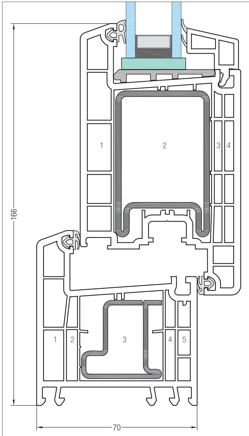
Глубина 70 мм, 5-камерное строение коробки, 4-камерное строение створки: в сочетании с крупноразмерным армированием позволяют изготовить входные двери, обладающие высокой жесткостью и хорошими теплоизоляционными свойствами.
